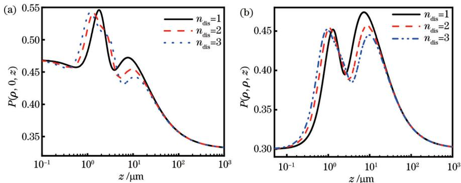
图 4 具有不同位错数目的光束偏振度  $P$  随  $z$  的变化。(a)  $P(\rho, 0, z)$ ; (b)  $P(\rho, \rho, z)$
