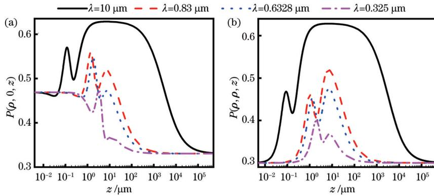
图 1 具有不同波长的光束偏振度  $P$  随  $z$  的变化。(a)  $P(\rho, 0, z)$ ; (b)  $P(\rho, \rho, z)$
