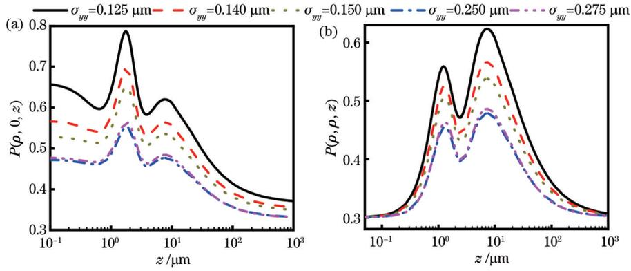
图 7 具有不同空间自相关长度的光束偏振度  $P$  随  $z$  的变化。(a)  $P(\rho, 0, z)$ ; (b)  $P(\rho, \rho, z)$
