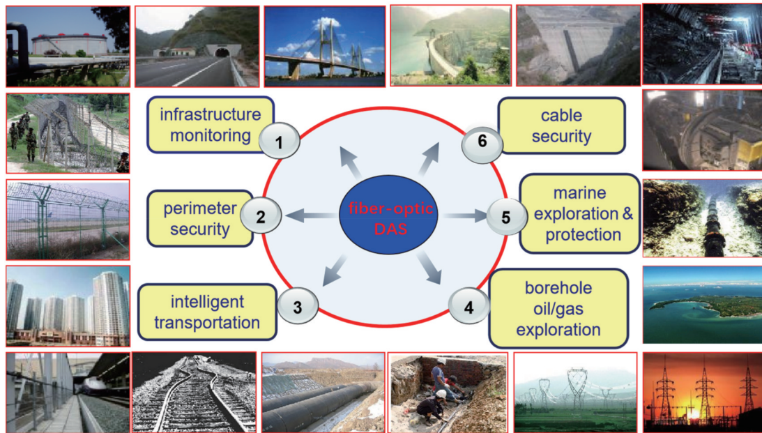
图1 新一代城市物联网的感知基础——基于通信光缆感知的分布式光纤声波传感器
