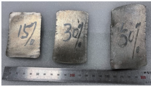
图 2 不同热轧压下量处理的沉积试样
