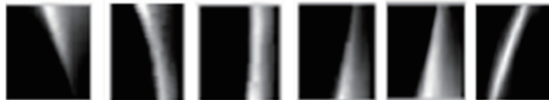
图 4 灰度化后等离子体图像边缘区域 Fig. 4 Plasma image edge region after gray processing
