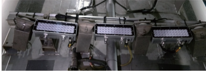
图 4 采用蓝光 LED 频闪照明技术的接触网几何参数测量系统
