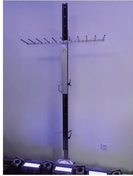
图8 线阵相机标定架
