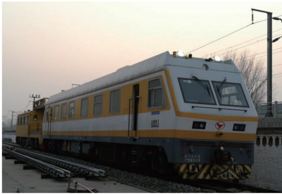
图 9 高速铁路专用的接触网检测车
