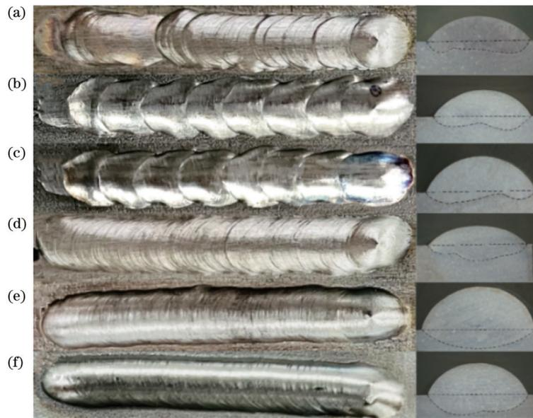
图 9 沉积熔道形貌及横截面示意图。(a)  $P_{\text{Si}}=36\%$ ; (b)  $P_{\text{Si}}=50\%$ ; (c)  $P_{\text{Si}}=58\%$ ; (d)  $P_{\text{Si}}=65\%$ ; (e)  $P_{\text{Si}}=70\%$ ; (f)  $P_{\text{Si}}=73\%$
