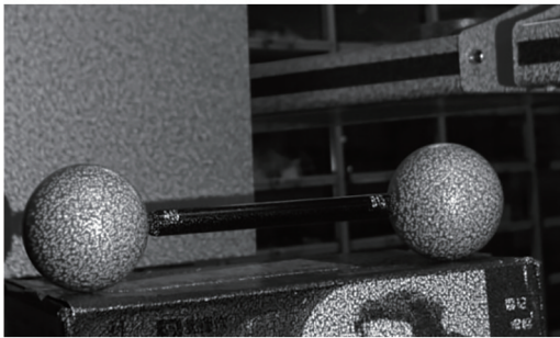
图 8 标准球散斑图像 Fig. 8 Speckle image of standard spheres
