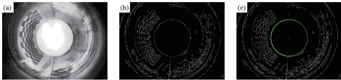
图 5 预处理及圆心检测结果。(a)预处理结果;(b)边缘检测结果;(c)圆心检测结果
