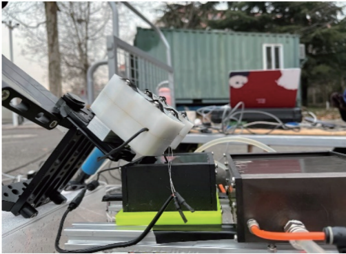
图 8 海水模拟器水面温度校正的室外实验现场情况图
