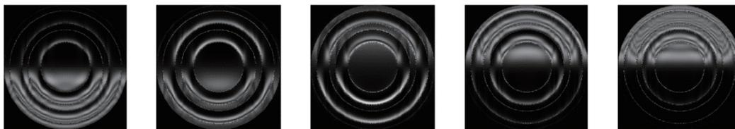
图 6 Zemax 光学设计软件模拟的一系列沿光轴分布的刀口阴影检测图
