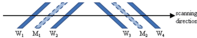
图 26 TTL 对准标记示意图 [31]
