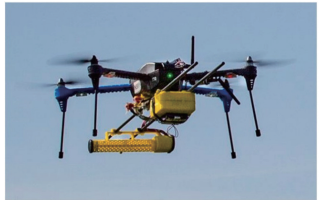
图 8 无人机携带小型化的甲烷气体传感器 [82]
