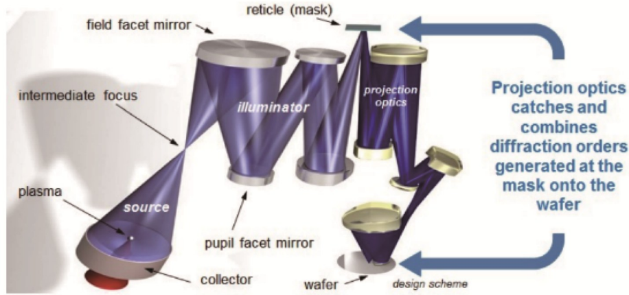
图2 EUV光刻照明和物镜示意图 [5]
