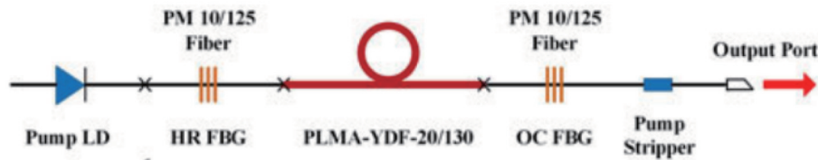
图 13 单模-多模-单模振荡器结构 [9]
