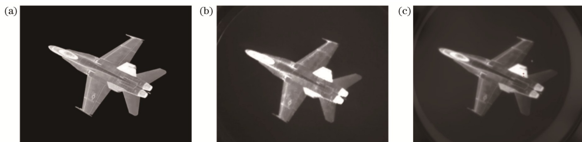
图 5 光热图像转换阵列生成的红外图像。(a)数字输入图像;(b) 3~5 \mu\text{m} 红外图像;(c) 8~12 \mu\text{m} 红外图像 Fig. 5 Infrared images generated by photothermal image conversion array. (a) Input digital image; (b) 3~5 \mu\text{m} infrared image; (c) 8~12 \mu\text{m} infrared image
