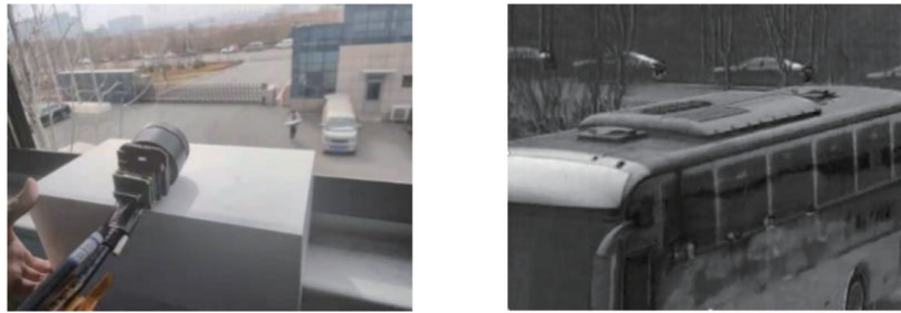
图 7 非制冷偏振热成像实验系统及其偏振度图像
