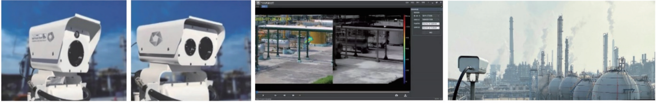
图 4 用于化工园区、油气田的工业气体泄漏气云红外成像检测仪及其应用场景
