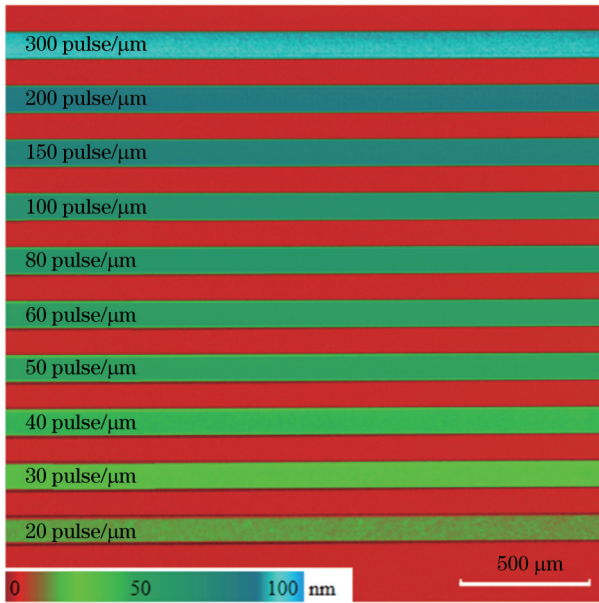
图 4 加工深度为 200 \mu\text{m} 、脉冲能量为 0.3 \mu\text{J} 时,不同的脉冲密度对纳米光栅相位延迟量的影响
