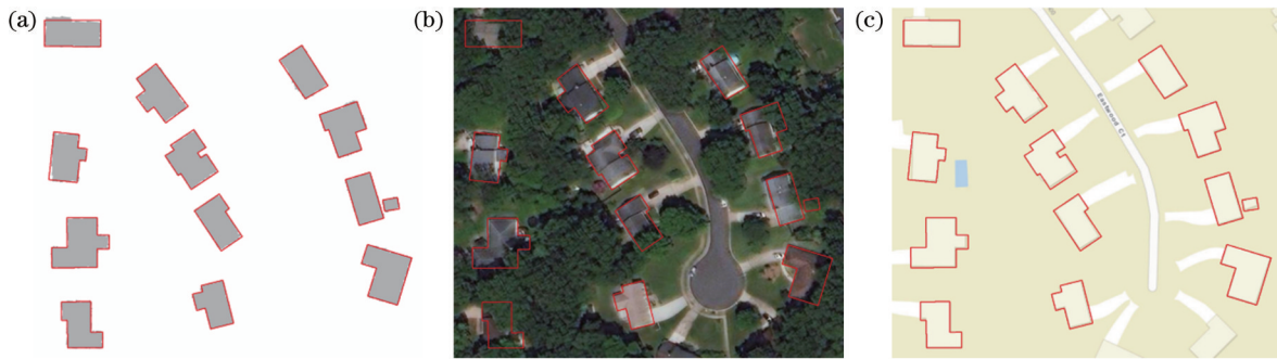
图 13 建筑物轮廓优化效果。(a)优化结果叠加初始轮廓;(b)优化结果叠加遥感影像;(c)优化结果叠加街道地图
