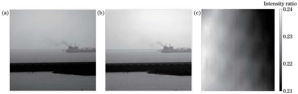
图 11 船舶烟羽原始图像。(a) 310 nm 通道捕获的原始图像; (b) 330 nm 通道捕获的原始图像; (c) 两个通道的人工背景图像的数量比
