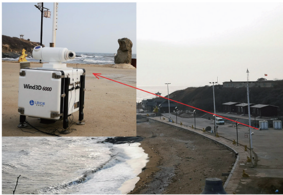
图1 观测场地与测风激光雷达系统照片
