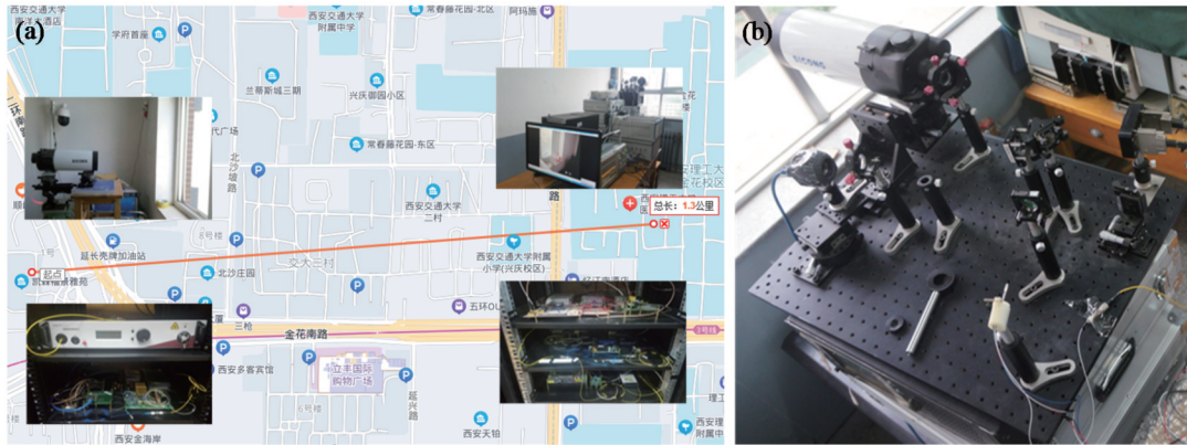
图 9 1.3 km 的外场实验。(a) 实验链路图;(b) 接收端实物图
