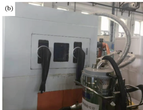
图 2 增减材复合机床。(a)主要结构;(b)外观
