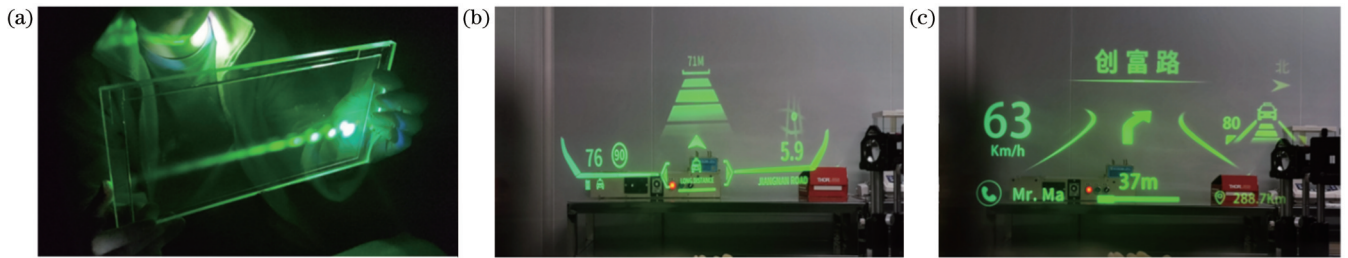
图 9 全息光波导和增强现实显示效果。(a)图像光在波导内传输;(b)(c)增强现实显示效果
