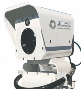
图 2 宽波段气体红外成像系统
