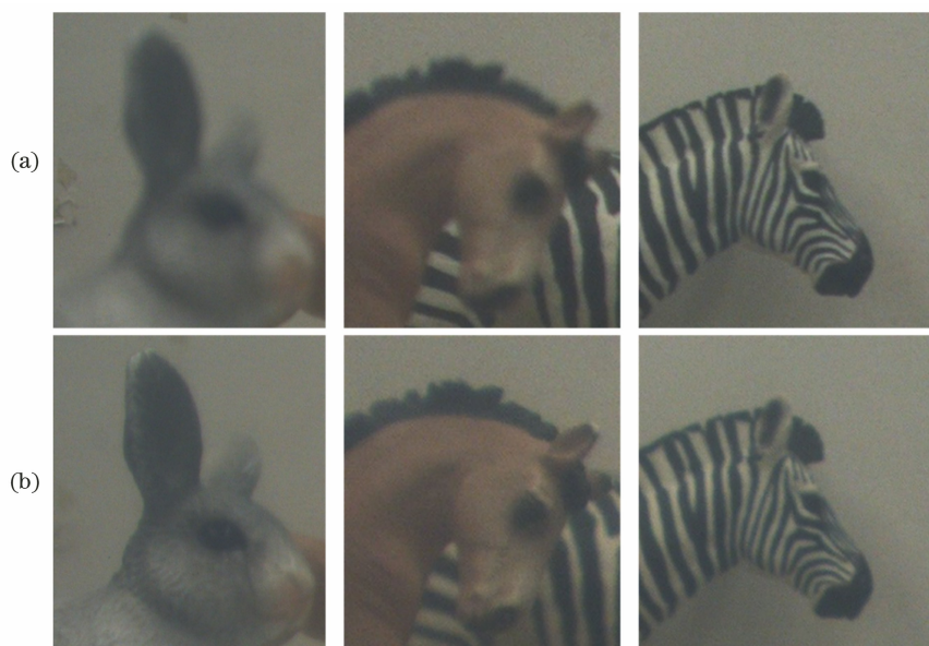
图 10 对液晶轴棱锥施加电压前后的系统成像效果。(a)液晶轴棱锥不工作时的成像效果;(b)液晶轴棱锥工作时的成像效果
