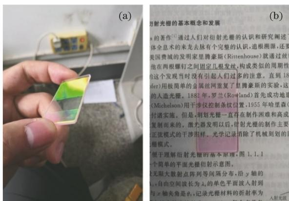
图 12 双重体光栅全息波导实物图和波导片透明度展示图。
