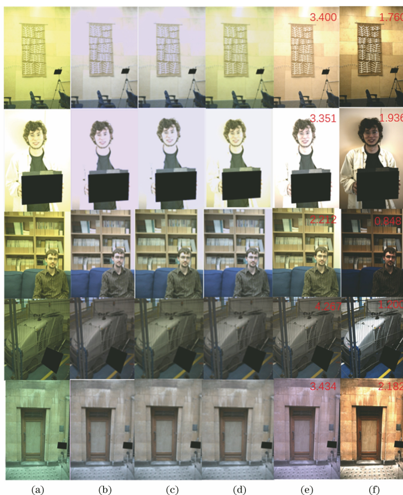
图 5 复杂场景光照下颜色恒常性算法对比。(a)输入图像;(b) grey-world 算法;(c) grey-edge 算法;(d) FC4 算法;(e) C4 算法;(f)本文算法
