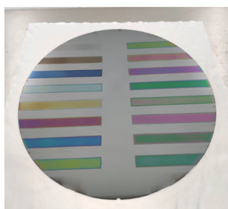
图 5 \text{SiO}_2 膜层工艺硅片样品实物图
