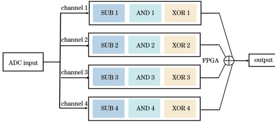
图 4 Toeplitz后处理四通道流程设计框架
