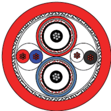
图 10 CERN SPA6线缆结构示意图
