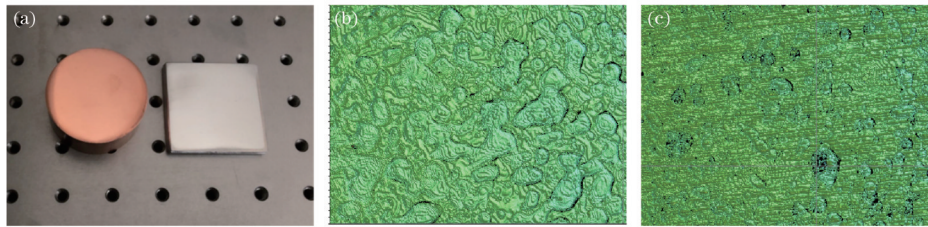
图 4 样品及其表面微面形貌的测量结果。(a)待测样品;(b)涂漆铜表面的微观形貌;(c)涂漆铝表面的微观形貌
