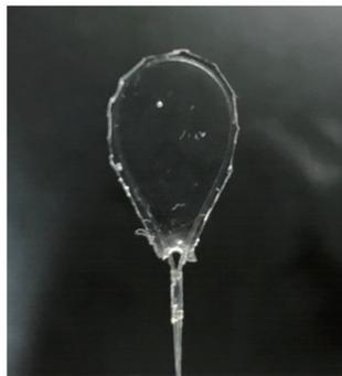
图 3 水滴型光纤传感器实物图
