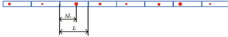
图 2 光纤离散化瑞利散射模型
