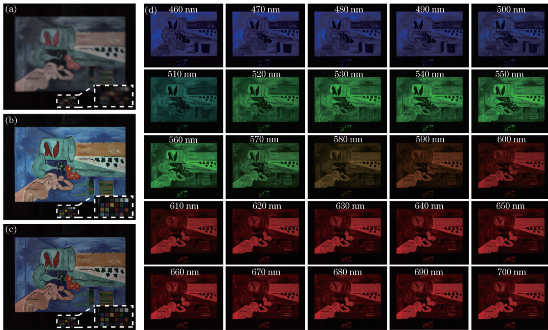
图 10 仿真重建结果。(a)生成的旋转衍射模糊图像;(b)重建光谱数据全谱段可视化图像;(c)标准数据集全谱段可视化图像;(d)各个光谱通道的图像
