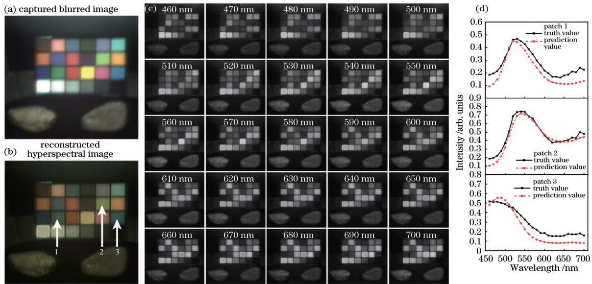
图 12 实拍图像的重建结果。(a) 实拍的旋转衍射模糊图像；(b) 重建高光谱图像的 RGB 可视化图像；(c) 单通道光谱图像；(d) 选取色块的光谱曲线
