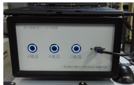
图 2 光子晶体光纤气压控制设备
