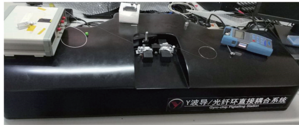
图 7 光纤环与集成光学芯片直接耦合系统
