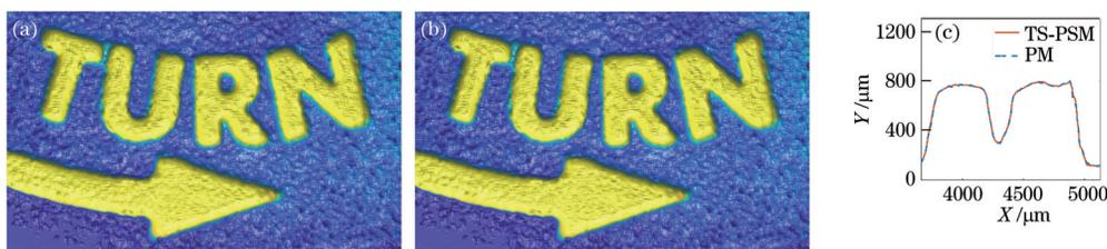
图 8 实验结果。(a) TS-PSM 重建结果；(b) PM 重建结果；(c)剖面图对比
