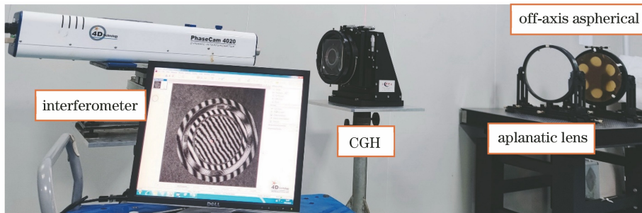
图 10 试验镜 CGH 折衍混合补偿检测的实际测试光路
