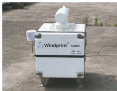
图 1 S4000 型相干多普勒测风激光雷达系统
