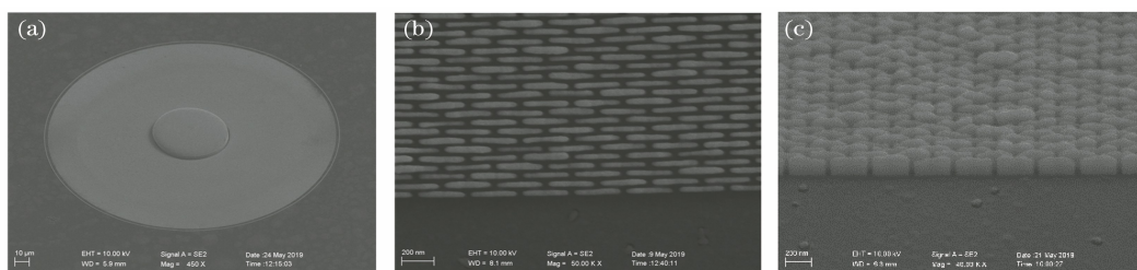
图 14 采用电子束光刻结合脉冲电镀成功研制的 30 nm 软 X 射线波带片透镜 [47]
