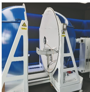
图 7 有效辐照面稳定性测试
