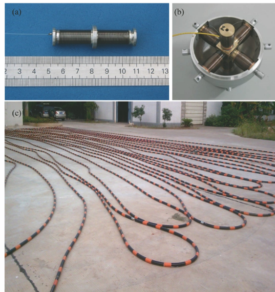
图 6 光纤水听器探头和阵列实物图。(a)光纤声压水听器;(b)光纤矢量水听器 [40] ;(c)光纤水听器阵列
