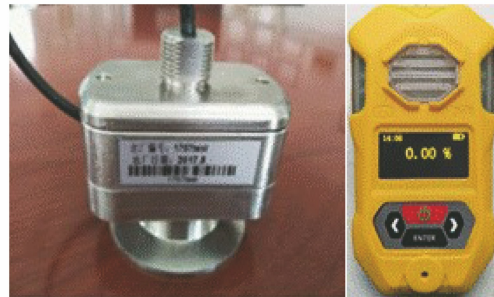
图 15 激光甲烷传感器模块和激光甲烷便携仪 [143]
