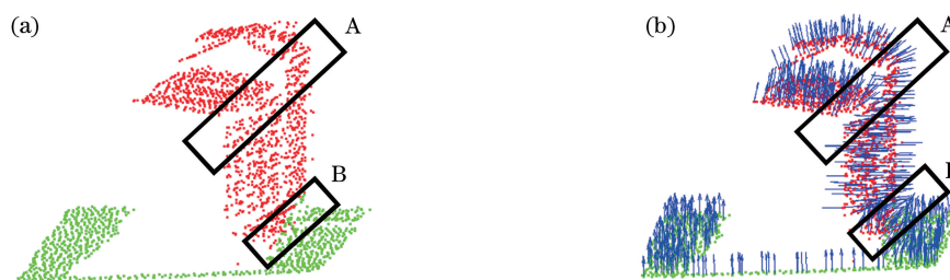
图 3 法向量示例。(a)点云数据;(b)点云法向量
