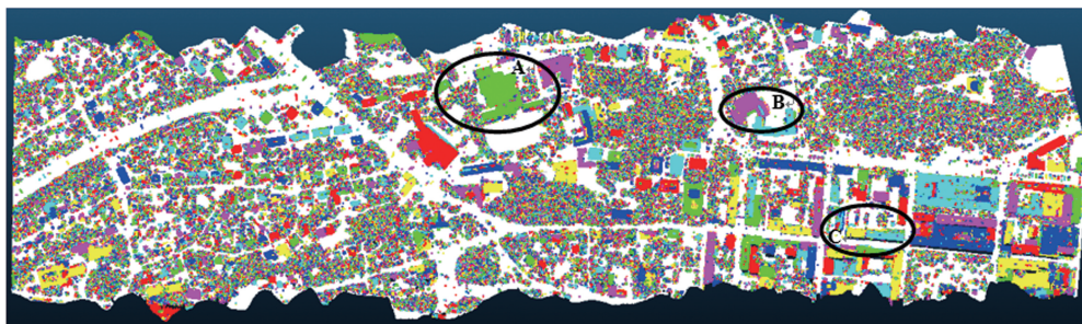
图 1 基于 RG 算法的点云多要素分割示例
