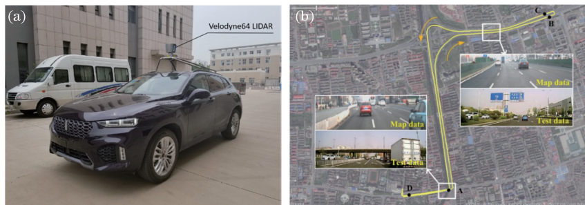
图 10 实车数据集。(a)采集平台;(b)实验路段的卫星地图
