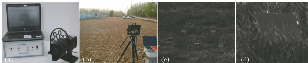
图 5 实验设备与实验环境。(a) SALSAs 偏振相机系统; (b) 室外拍摄; (c) 目标放置于草地; (d) 裁剪的目标样本
