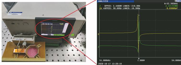
图 9 样品 PEM 频率-阻抗实测图
