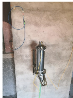
图 13 双光纤光栅静力水准仪的工程应用
