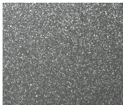
图 7 0.2 \mu\text{m} 样块激光散斑图案
