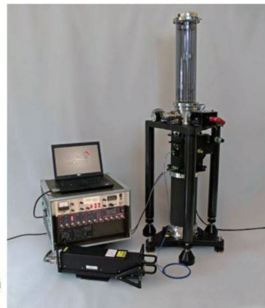
图 4 Micro-g Lacoste 公司的 FG5 和 FG5X 型绝对重力仪 [5-6]
