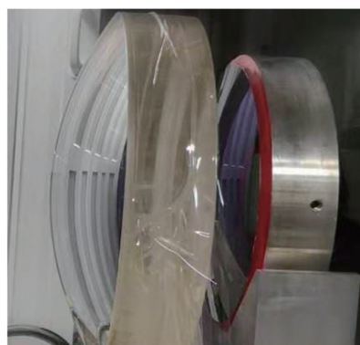
图 6 自准校正透镜检验凸非球面的实物图
