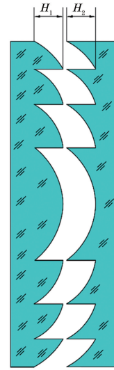
图 1 双层衍射光学元件的结构示意图
